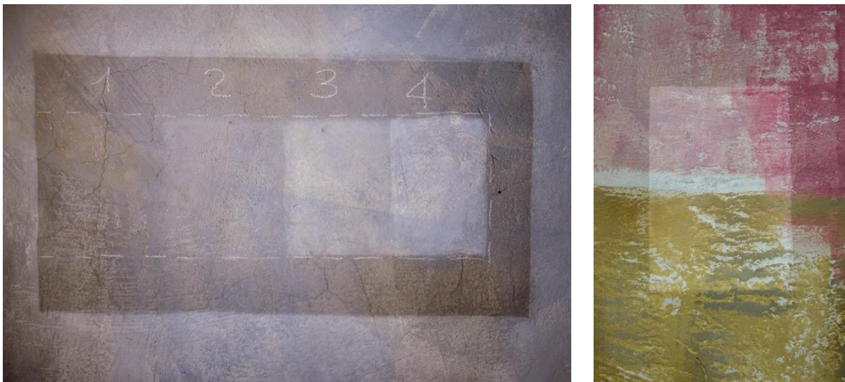
Fig. 9. Campioni di pulitura a confronto: area n.1 Superficie non trattata, area n. 2 Wishab bianca, area n. 3 SmokeSponge , n.4 pulitura c gomma Staedtler Rasoplast . Fig. 10. Tassello di pulitura con SmokeSponge abside destro.
