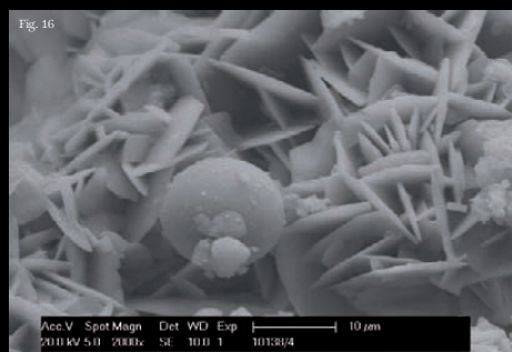
Fig. 15 Micrografia al SEM, superficie del campione 4, prospetto est. In evidenza globulo di provenienza atmosferica di natura biologica.
