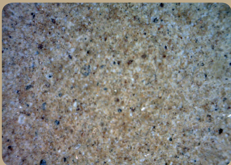
Fig. 3b - Superficie dopo la pulitura con vapore (55x) (E. Zendri)
