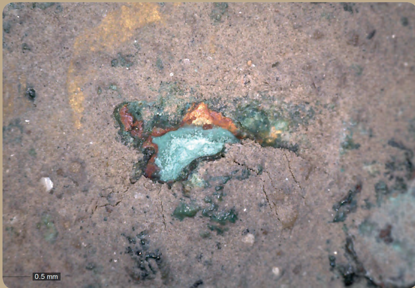
Fig. 9 - Foto al microscopio a contatto relativa al reperto 5155 (60x). È visibile lo strato di degrado superficiale del piombo (C. Frigatti)
