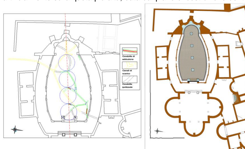
Fig. 10. Ricostruzione dei giochi d'acqua dello Xystus (a destra), attraverso lo schema geometrico sotteso al progetto (a sinistra). (Disegno: E. Gallochio).
