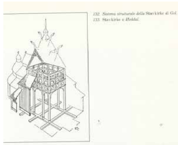
Sistema strutturale della Stavekirke di Gol, Stavekirke a Heddal
