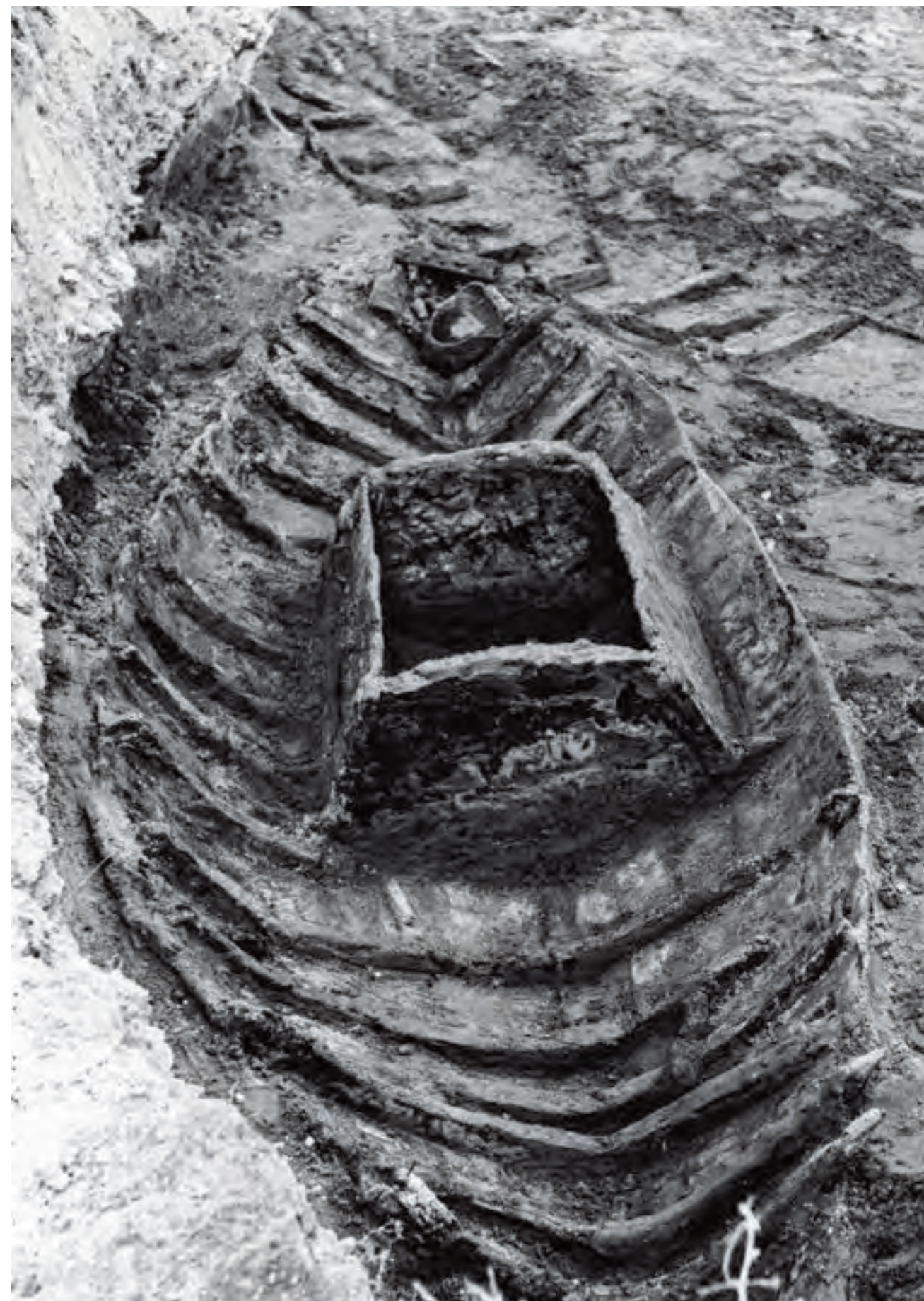
11. Navis vivaria romana de Roma ("Fiumicino 5"), con vasca centrale per mantenere vivo il pescato (Boetto 2002).
