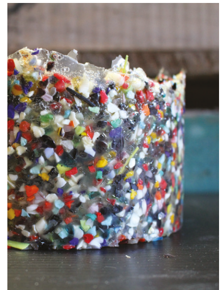
07. Prototipo sperimentale realizzato con frammenti di vetro e matrice di origine naturale | Experimental prototype made of glass fragments and matrix of natural origin. P. Careno, S. Centenaro, F. De Benedetti
